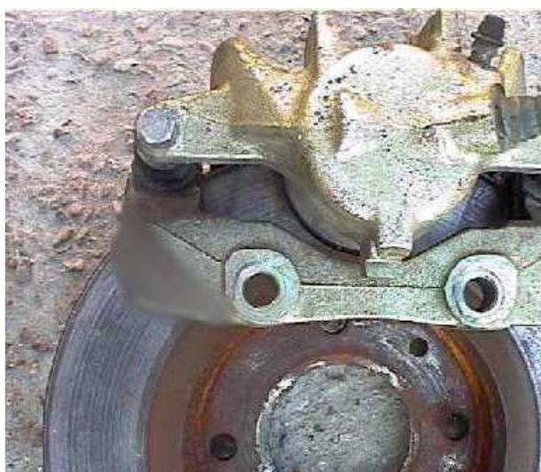
*On aperçois bien de l'endroit qu'il faut disquer en bas à gauche de l'étrier, afin qu'il rentre sur le pivot de la 106 d'origine.*
