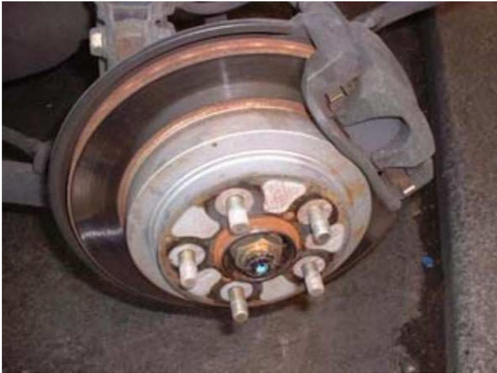
Ensuite, il convient de déposer l'étrier pour accéder aux plaquettes de freins. Pour ce faire, dévissez tout simplement les deux écrous de 15 qui fixent l'étrier sur la platine. Attention à ne pas abîmer les flexibles de freins lors de la dépose de l'étrier !
