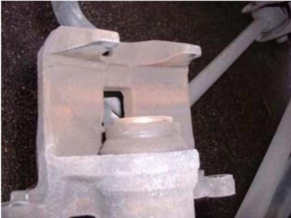
Maintenant, vous pouvez retirer par le dessus les plaquettes de frein usées, en prenant soin de ne pas perdre les plaquettes métalliques anti-vibrations et les guides métalliques (qui transmettent l'effort du piston aux deux plaquettes).
